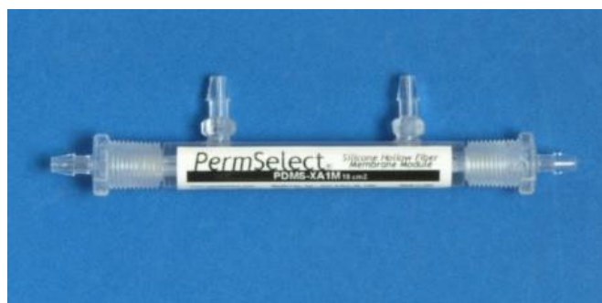
4. ábra Felhasznált membránmodul (permselect.com)
