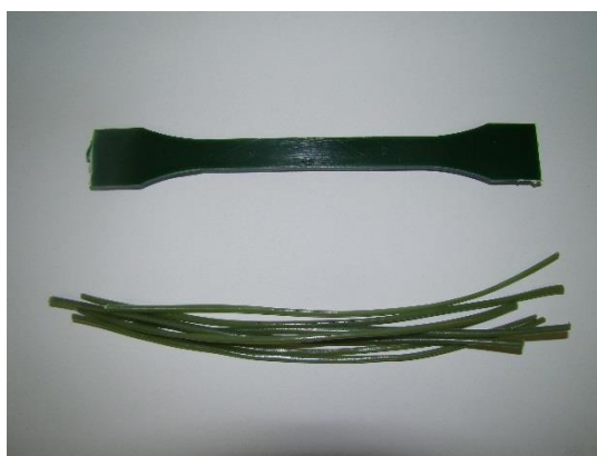
17. ábra A mechanikai vizsgálatokhoz alkalmazott extrudált szálak és fröccsöntött próbatest
