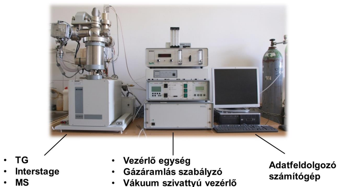
11. ábra: NETZSCH STA 409 CD + QMS 403/5 tömeg-spektrométer, SKIMMER kapcsolódással
