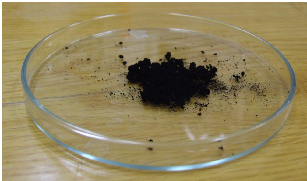
6. ábra: Impregnált szén nanocsövekből álló minta
