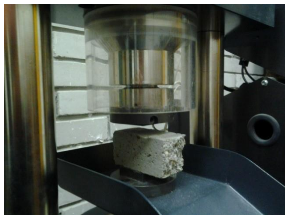
14. ábra: Nyomószilárdság meghatározása
