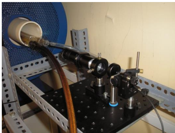
29. ábra: A szén nanocső erdő magasság figyelő rendszer működés közben
