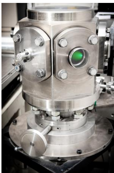
4. ábra: A vákuumkamra működés közben (az ablakon keresztül látható a zöld plazmakúp)
