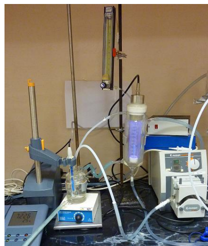
7. ábra: A VUV-fotolízis során alkalmazott berendezés sematikus ábrája és fényképe
