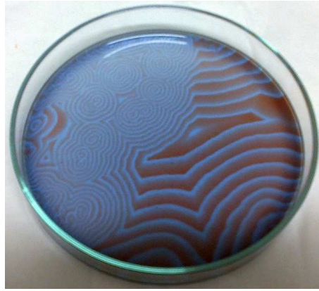
1. ábra. A Belouszov-Zsabotyinszkij reakcióban megfigyelhető kémiai hullámok változatos formái.
