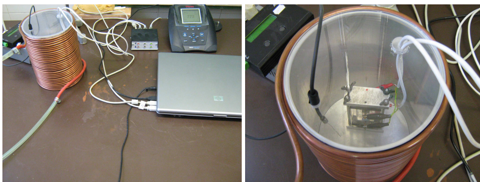
18. ábra. A kísérleti elrendezés részletei. A bal oldalon: az adatgyűjtést végző számítógép mögött látható a konduktométer, mellette pedig az áramkörök közti váltást végző relé, a termosztált tartály bekötő műanyag csöveivel és a termoelem külső egysége; a jobb oldalon: a termosztált tartály, benne a cellával és a termoelem mérőszálával.
