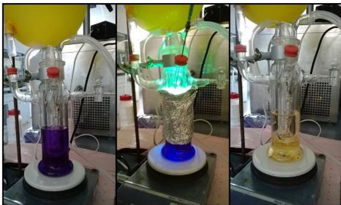
15. ábra A fotoreaktor működés előtt, reakció közben és a reakció végeztével
