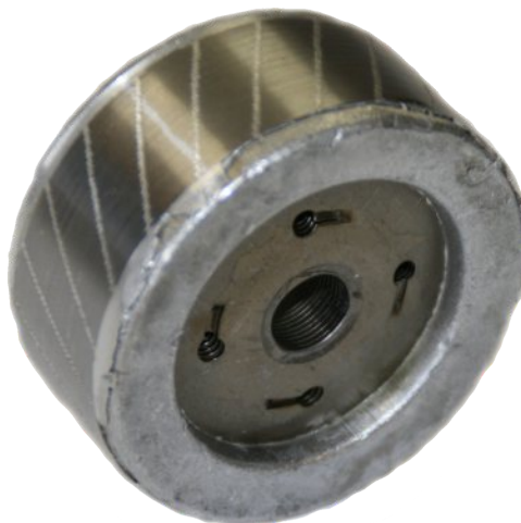
5.1. ábra. Az eredeti 44 mm átmérőjű forgórész
