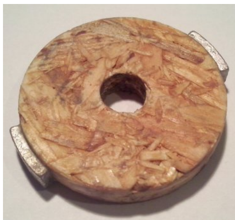
6.3. ábra. Az elkészített mágneses jeladó
