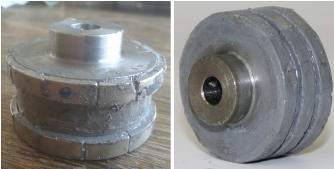
5.7. ábra. Az elkészített kvázi-hengeres forgórész
