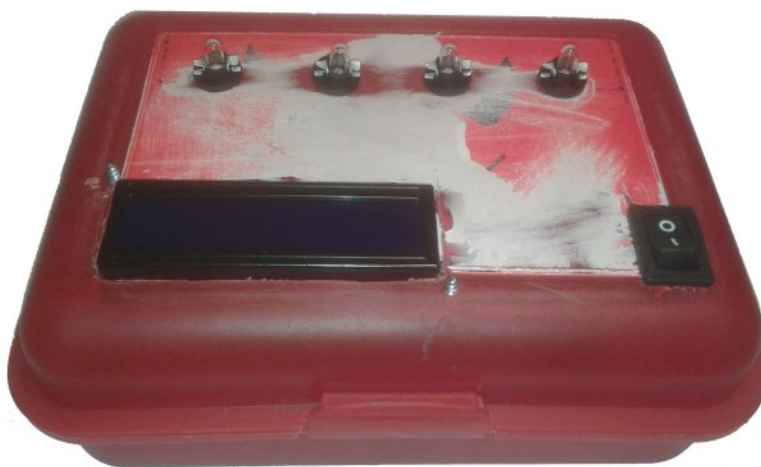
8.11. ábra. Az összeszerelt elektronika, fogyasztókkal és kijelzővel
