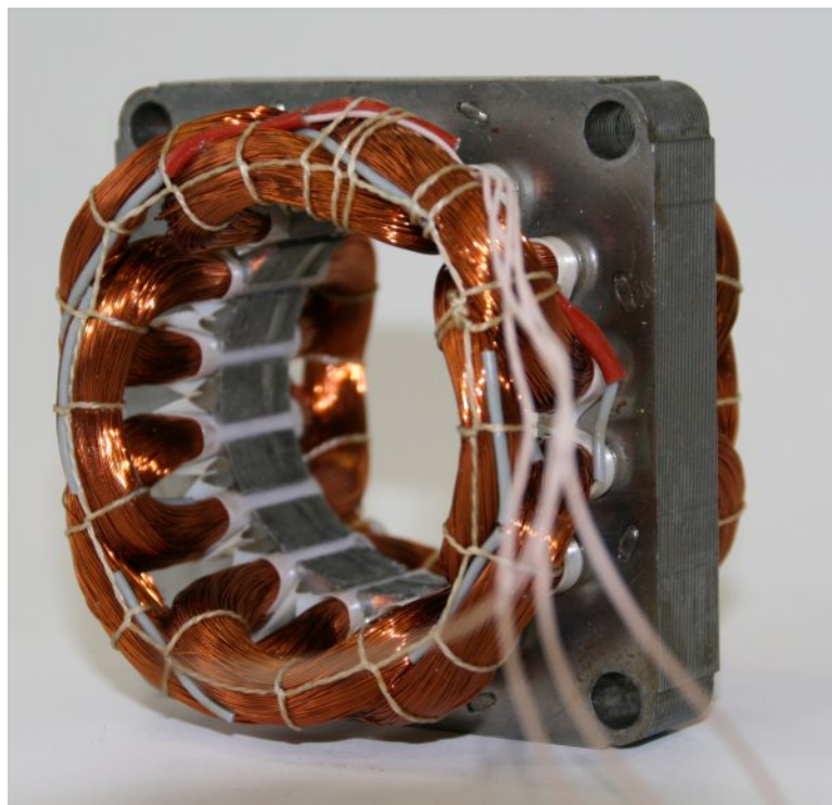
4.3. ábra. A megvalósított állórész-tekerceslés
