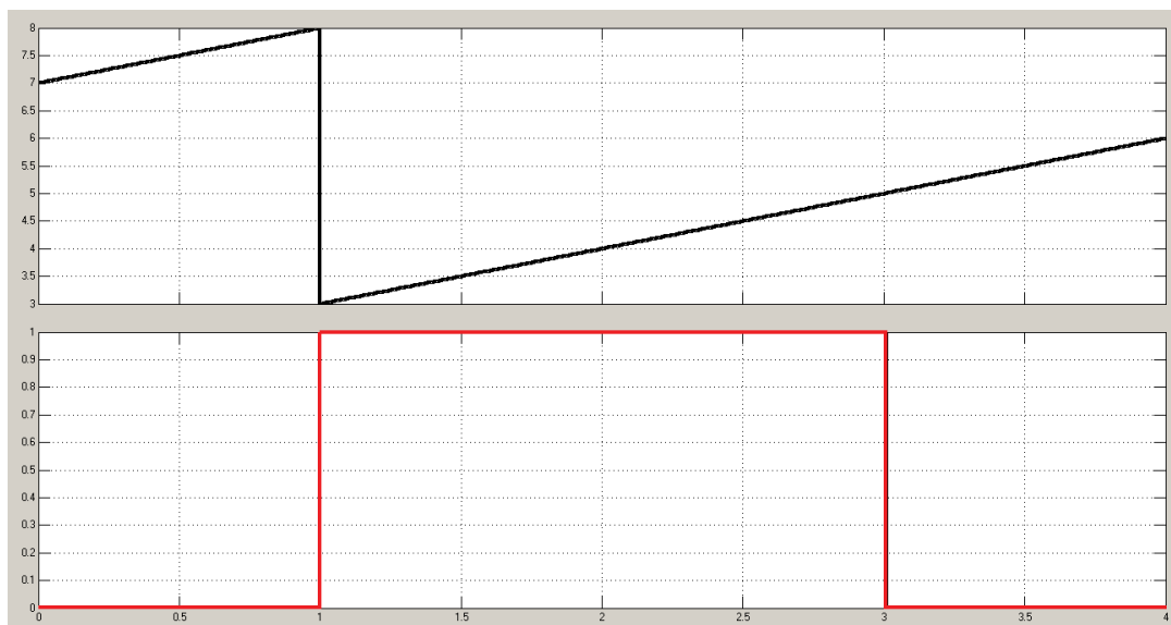
7.3. ábra. A termelést engedélyező logikai működése (—) és a fordulatszám (—)
