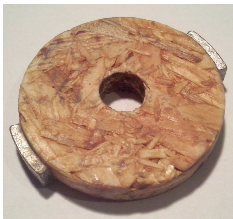
6.3. ábra. Az elkészített mágneses jeladó
