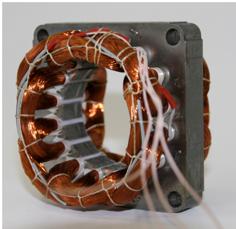
4.3. ábra. A megvalósított állórész-tekerceslés
