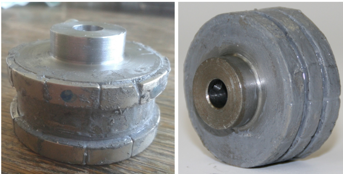
5.7. ábra. Az elkészített kvázi-hengeres forgórész
