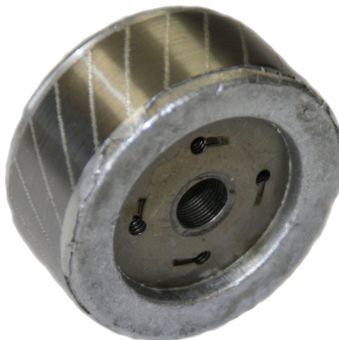
5.1. ábra. Az eredeti 44 mm átmérőjű forgórész
