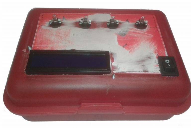
8.11. ábra. Az összeszerelt elektronika, fogyasztókkal és kijelzővel
