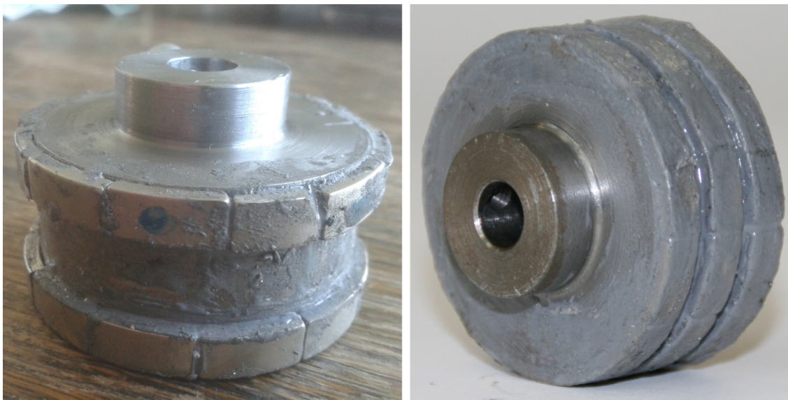
5.7. ábra. Az elkészített kvázi-hengeres forgórész
