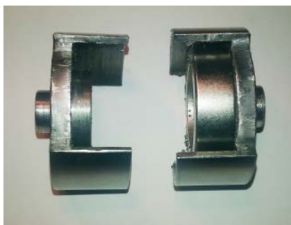
(a) A megvalósított pajzsok és az egyikben elhelyezkedő mágnes
