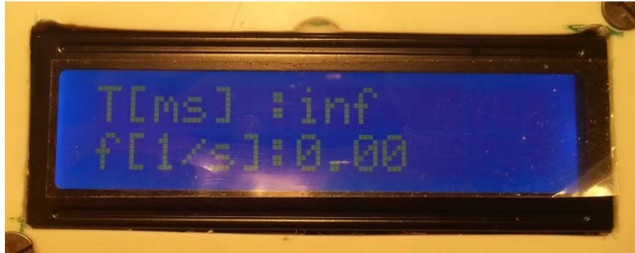
5.8. ábra. A mérések eredménye bekapcsolást követően illetve túl hosszú periódusidő esetén
