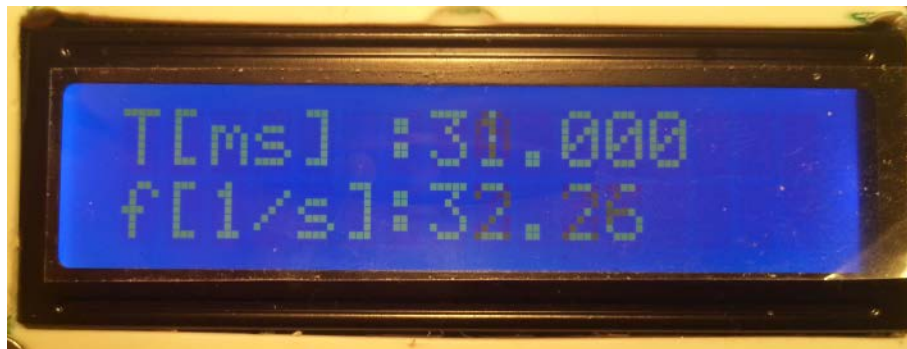
5.9. ábra. Mérési eredmény f = 30\text{Hz} közelében
