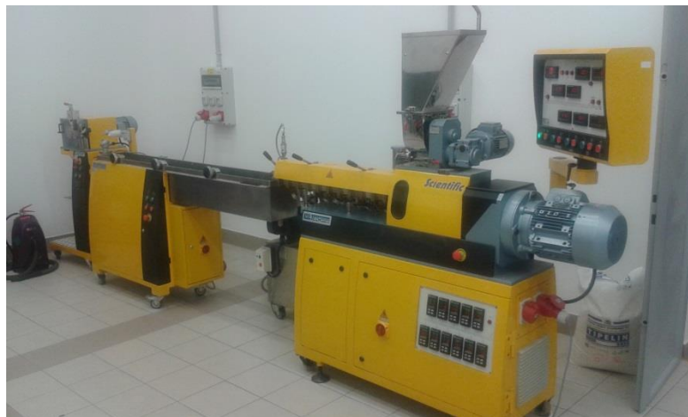
12. ábra. LAB-Tech LHFS 1 Scientific típusú extrúder
