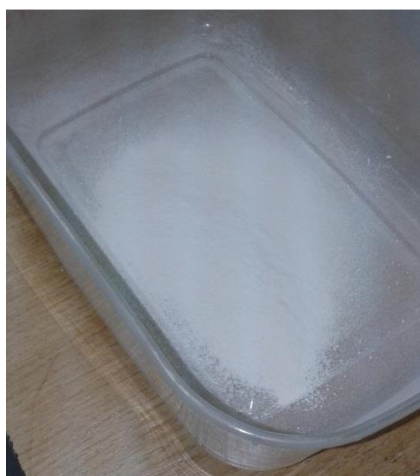
11. ábra. Montmorillonit ásvány az őrlés után
