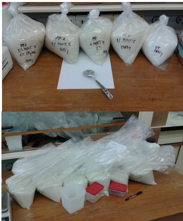
16. ábra. Extrudálással előállított kompozit granulátum
