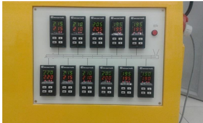
14. ábra Extruder fűtőzónák hőmérséklete
