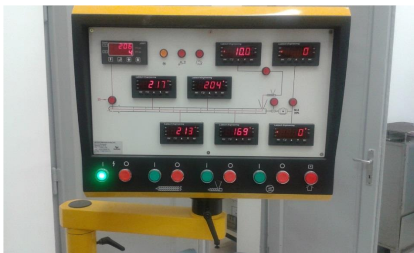
13. ábra. Extruder kezelőfelülete
