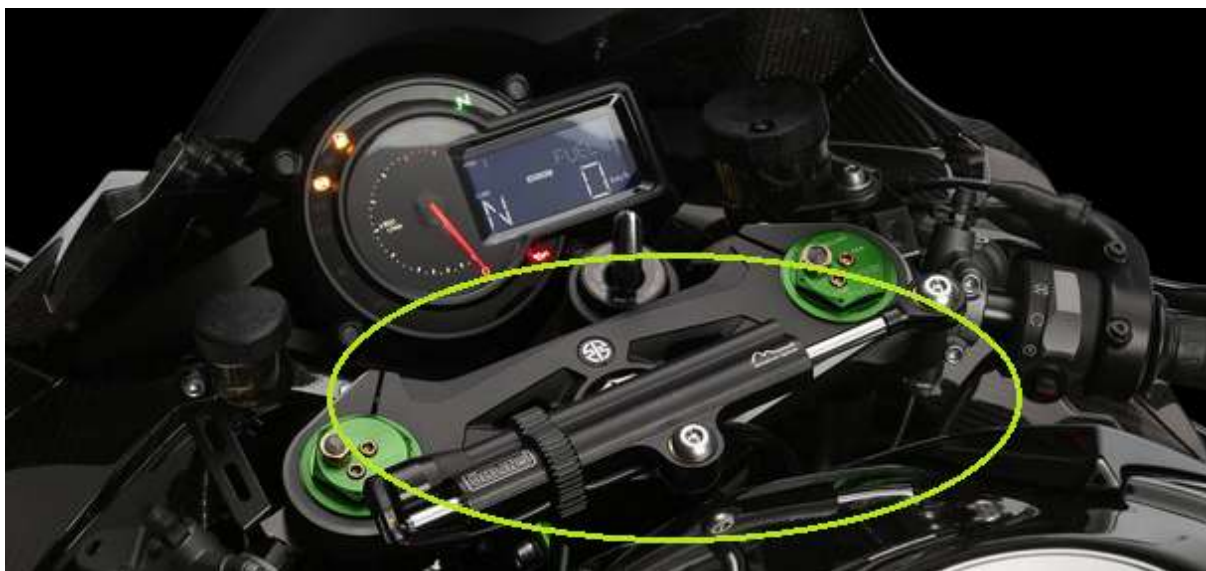
25. ábra: A mai sportmotorok már elképzelhetetlenek kormány-lengéscsillapító nélkül. [28]
