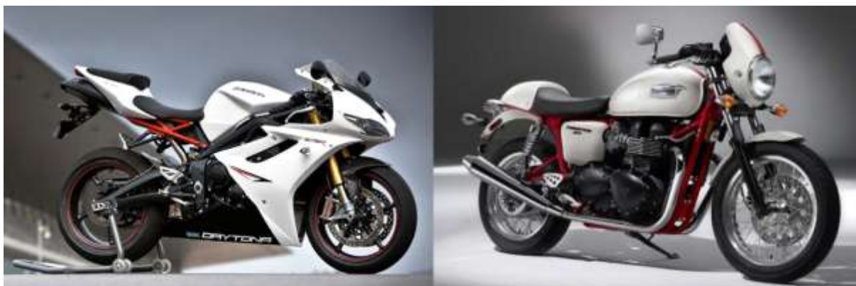
9. ábra: Nagyteljesítményű motorokon az első keréken dupla, nagyméretű tárcsafékek, míg hátul egy kisebb tárcsafék; kisebb teljesítményű motorokon elől egy vagy két tárcsa-, míg hátul egy tárcsa- vagy dobfék található. [12]
