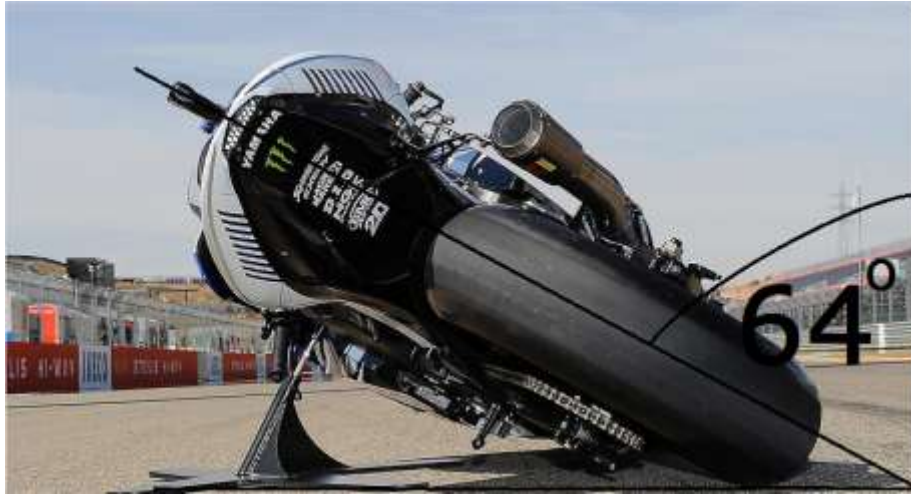
12. ábra: Egy GP motor maximális dönthetősége 64^\circ , ehhez képest egy szupersport motor 55^\circ , egy átlagos utcai motor 50^\circ , egy robogó 40^\circ -ig dönthető. [13]
