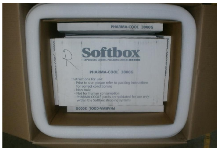
2. ábra: Hosszú távú szállításokra alkalmazott passzív hűtődoboz
