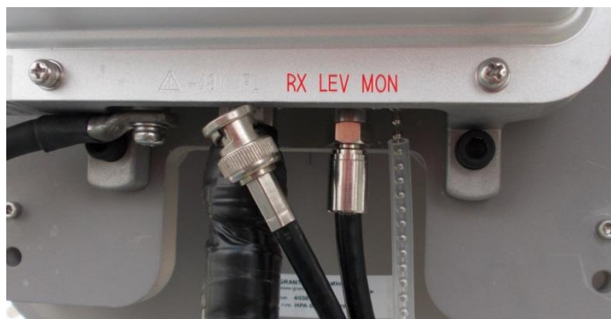
15. ábra: Csatlakozás az RX level porthoz
