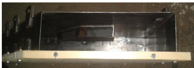
9. ábra: Bedolgozási irányra merőleges akadály
