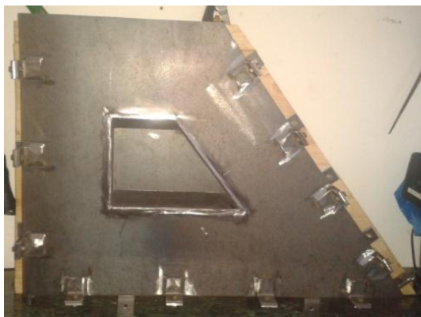
8. ábra: Alkalmazott fém zsaluhéj
