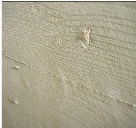
24. ábra: Betonlerakódás a 3. próbatest P3-mas felületén
