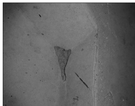
17. ábra: Légzárvány a 2. próbatest F2-F3 felület határán
