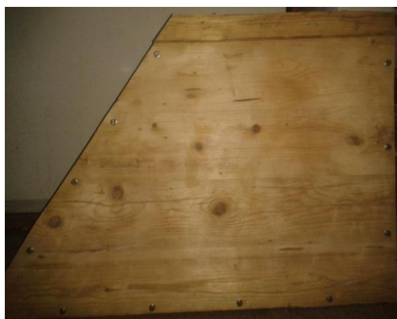
7. ábra: Alkalmazott háromrétegű zsaluhéj
