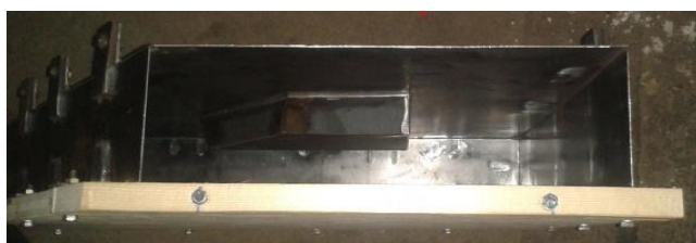
9. ábra: Bedolgozási irányra merőleges akadály
