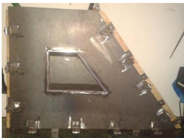
8. ábra: Alkalmazott fém zsaluhéj
