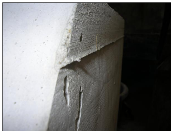
25. ábra: Zsalutábla toldásnál kialakult borda az első próbatest P3-mas, fa zsaluhéjjal készített felületén
