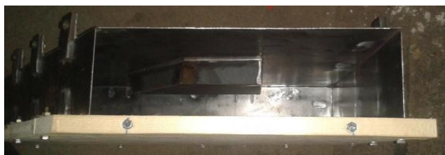
9. ábra: Bedolgozási irányra merőleges akadály
