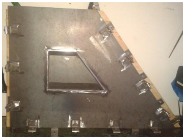
8. ábra: Alkalmazott fém zsaluhéj
