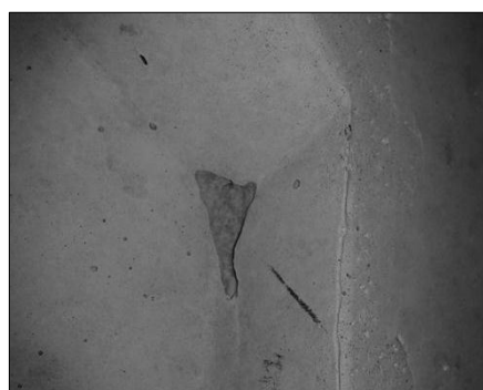
16. ábra: Légzárvány a 2. próbatest F2-F3 felület határán
