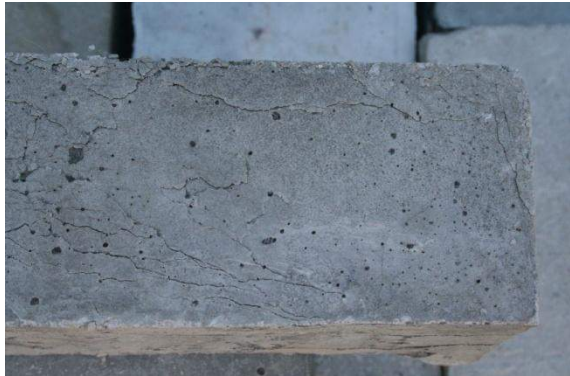
32. ábra - 10 fagycikluson átesett próbatest
