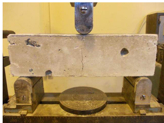
31. ábra - Pórusbeton adalékanyagos próbatétel tönkremenetele
