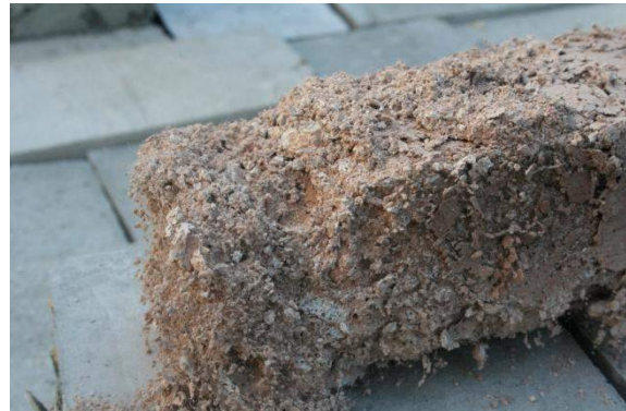
33. ábra - 25 fagycikluson átesett próbatest
