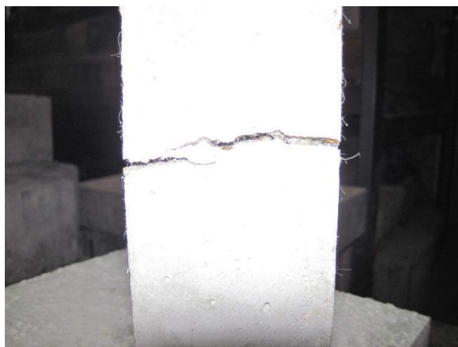
44. ábra - Repedést áthidaló PP szálak
