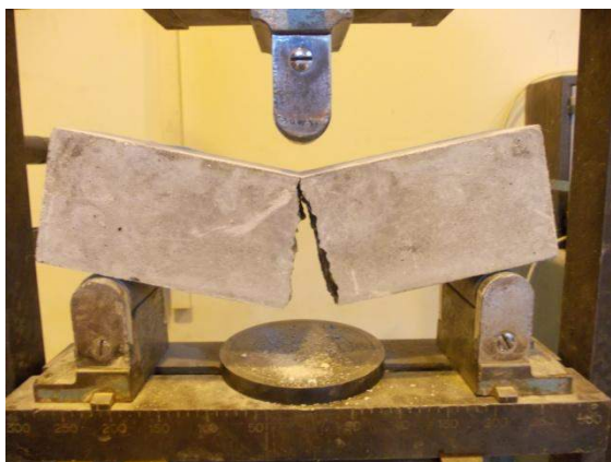
30. ábra - Kavicsbeton próbatétel tönkremenetele
