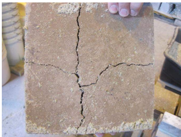
29. ábra - Tönkrement ütésállósági próbatest
