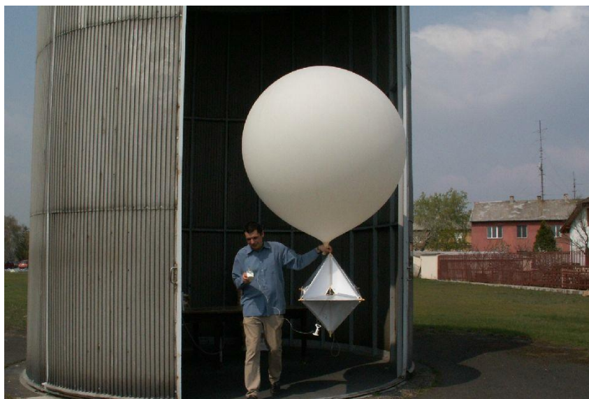
4. ábra: A ballonhoz erősítik a rádiószondát és egy szögletvisszaverőt (Országos Meteorológiai Szolgálat, Pestszentlőrinci Főobszervatórium)
