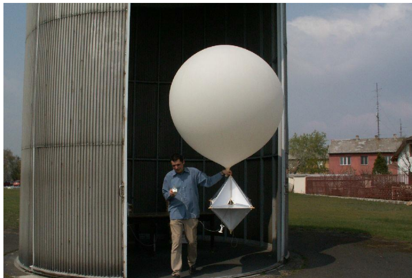
11. ábra: A ballonhoz erősítik a rádiószondát és egy szögletvisszaverőt (Országos Meteorológiai Szolgálat, Pestszentlőrinci Főobszervatórium)
