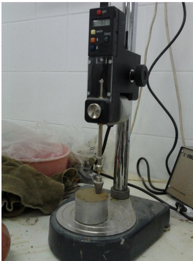
22. ábra: Ejtőkúpos vizsgálat
