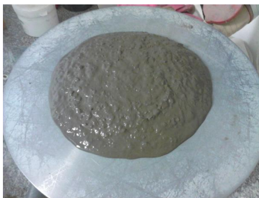
5.13 fénykép: Az első sorozat legmagasabb víz/kötőanyag arányú keveréke
