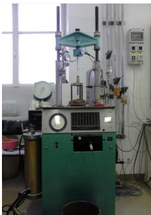
5.7 fénykép: Vizsgálatok során használt törőgép
