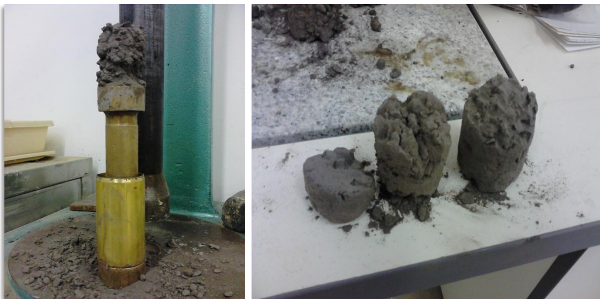
5.8 fénykép: Kis szilárdságú próbatestek nyomószilárdság mérés előtt
