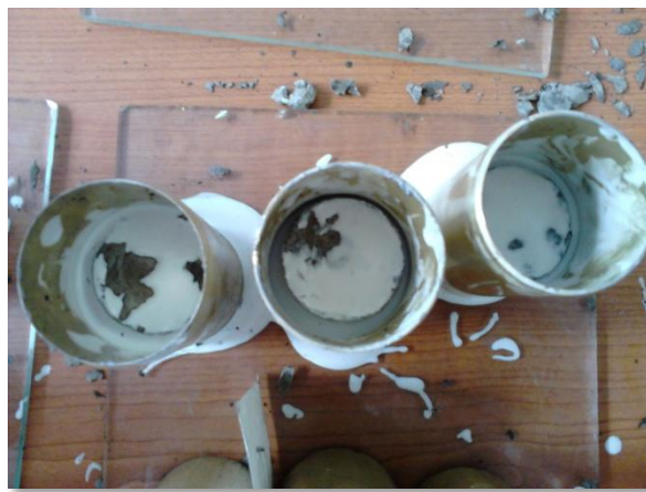
5.5 fénykép: Minták hézagkitöltés előtti és utáni állapotban
