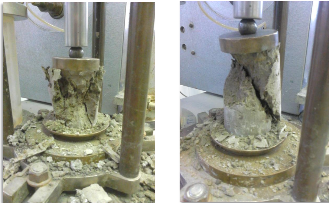
5.9 fénykép: Stabilizált talaj, különböző törésképei
