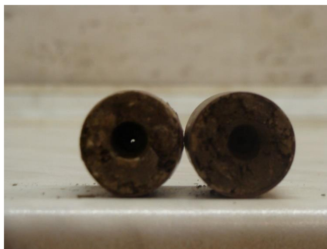
7.2.4. ábra A hidraulikus gradiens emelése következtében, a víz jobban megbontja a mintát és kitágítja a lukat.
