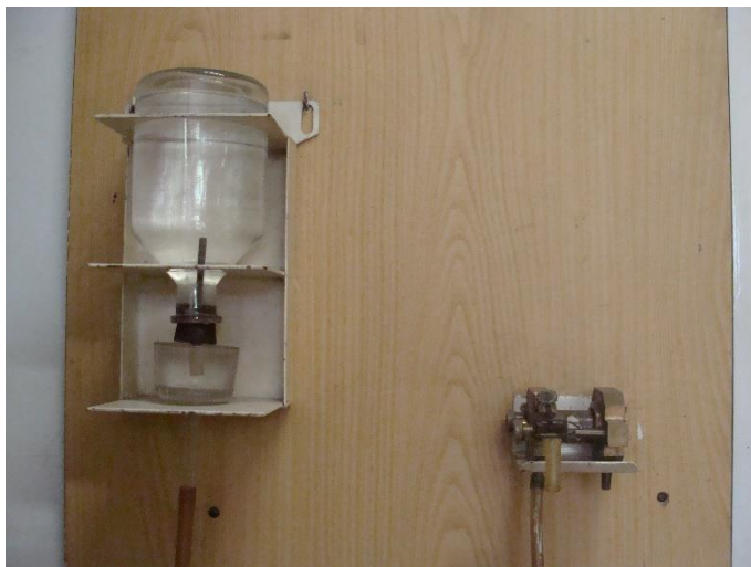
7.2.1. ábra Tűszúrás kísérlet elvégzéséhez szükséges eszközök. Balra desztillált vizes ballon jobbra a talajminta a tartóban.
