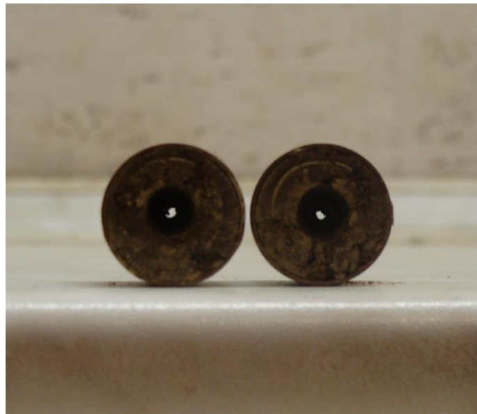
7.2.2. ábra A hidraulikus gradiens emelése következtében, a víz jobban megbontja a mintát és kitágítja a lukat.
