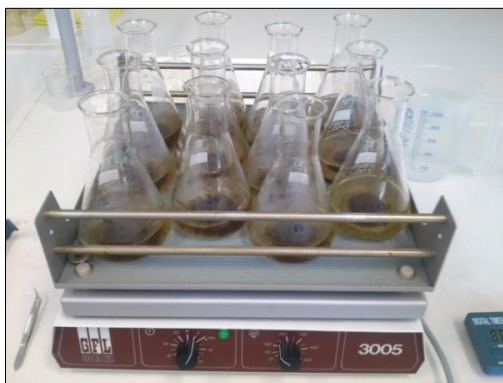
15. ábra Rázatás homok-zacc keverékkel
