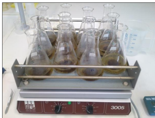
15. ábra Rázatás homok-zacc keverékkel
