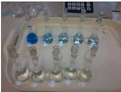
17. ábra Réz mérése fotometrián
