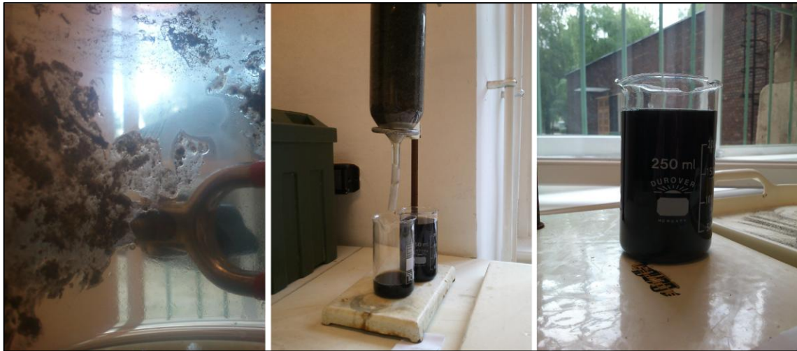
30. ábra Biológiai degradáció a töltetben
