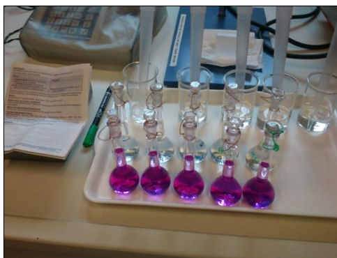
19. ábra Króm mérése fotometrián
