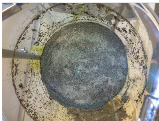
12. ábra A 20%-os töltet nedvesedettsége 3 nap száradás utáni újbóli méréskor
