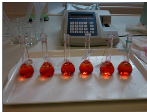
18. ábra Cink mérése fotometrián
