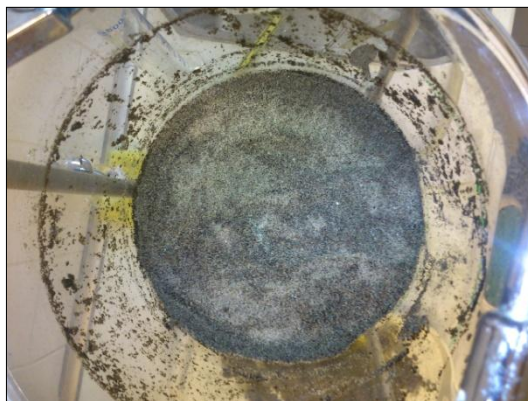
12. ábra A 20%-os töltet nedvesedettsége 3 nap száradás utáni újbóli méréskor
