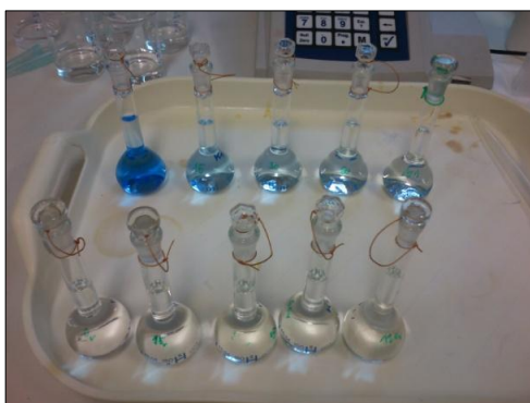
17. ábra Réz mérése fotometrián
