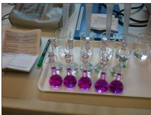
19. ábra Króm mérése fotometrián
