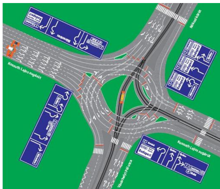
20. ábra Direkt irányítású jelzőlámpával szabályozott körforgalom (Szeged) 36
