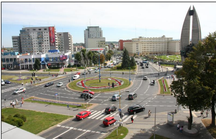
13. ábra Példa torkolatpáronkénti irányítás szerint működő csomópontra, Rzeszów, Lengyelország [41]
