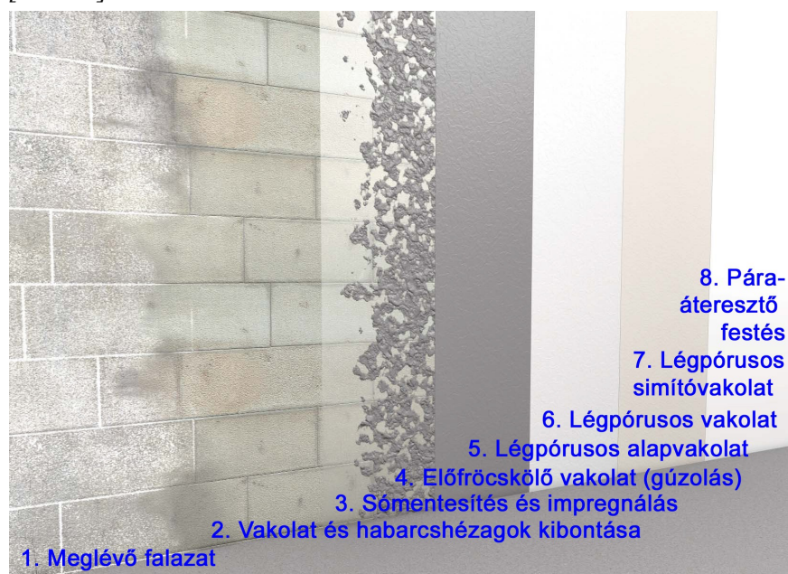
20. ábra. Légpórusos vakolatrendszer felépítése [www1.]
