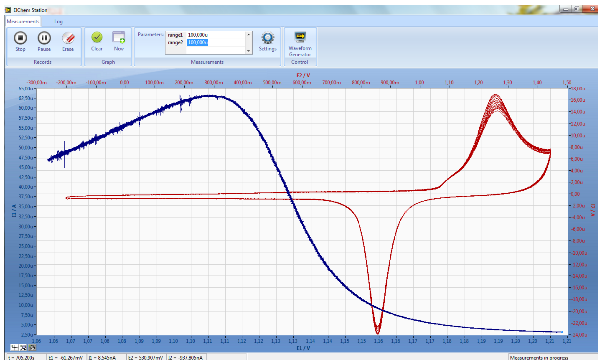
3. ábra. A dolgozatban közölt forgó gyűrűs korongelektrodos mérések végzésére használt szoftver főablaka működés közben.
