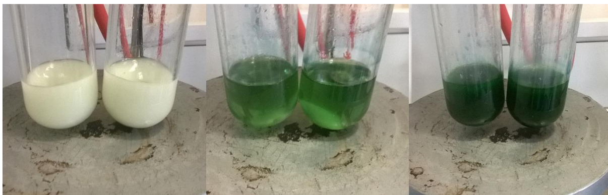
11. ábra: Sztírol oldata CuBr, PMDETA, valamint DBT bemérése után
