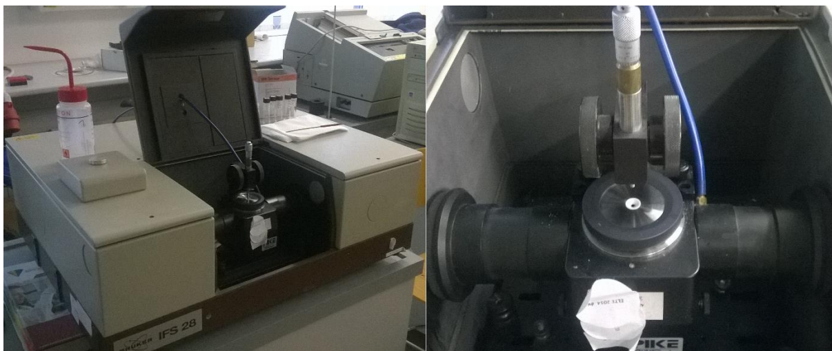
21. ábra: Polimerek analízisére használt FTIR-készülék (bal) és ATR-feltét (jobb)
