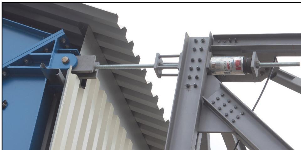
11. ábra A terhelő sajtó csatlakozása a kerethez
