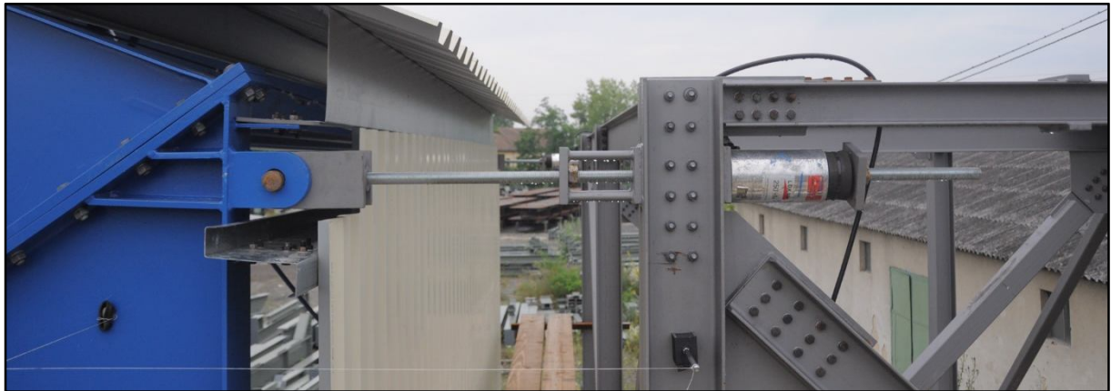
20. ábra Terhelő berendezés – hidraulikus sajtó
