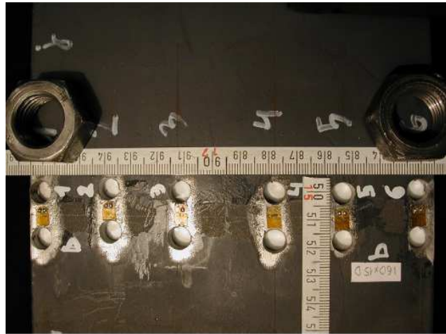
45. ábra: Egy I-szelvény övéén elhelyezett nyúlásmérő bélyegek és a furatok [5]
