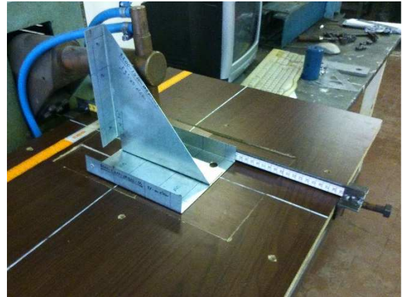
2.8 kép Elemek illesztése párhuzamvonalzók segítségével
