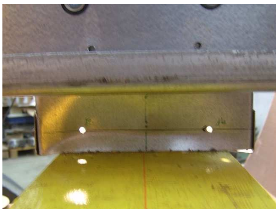
1.6 kép A deformálódott B200-...-01 tesztelem
