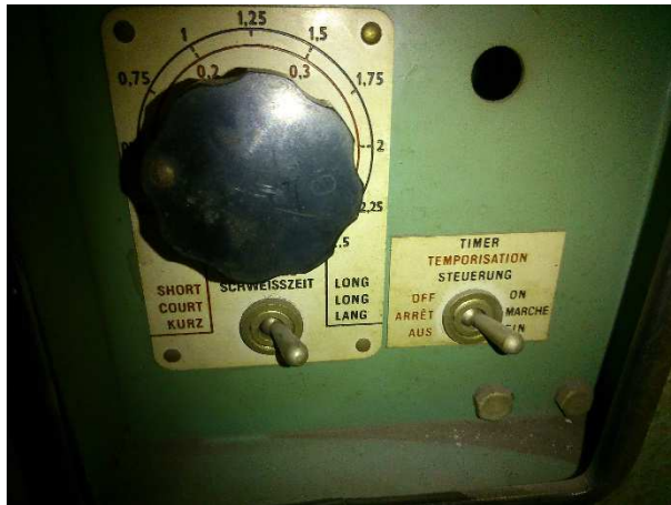
5.4 kép Az áramfolyás idejének beállítására szolgáló gomb
