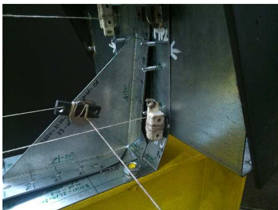
1.6 kép A deformálódott B200-...-01 tesztelem
