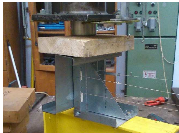
1.4 kép Terhelési viszonyok: fahasáb alkalmazása teherelosztás céljából
