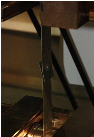
5.09 kép Kapcsolat befordulása erő irányba
