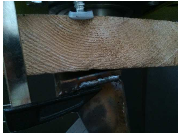
3.6 kép Fahasáb elfordulása a szelemen gerinc felső éle mentén
