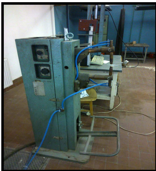
5.1 kép ARO M302-A típusú ellenállás hegesztő berendezés
