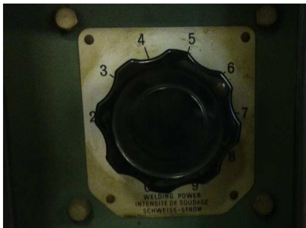
5.5 kép Lehetséges áramerősség beállítások (I1-I9)
