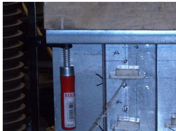
2.4 kép Terhelési viszonyok: fahasáb alkalmazása teherelosztás céljából
