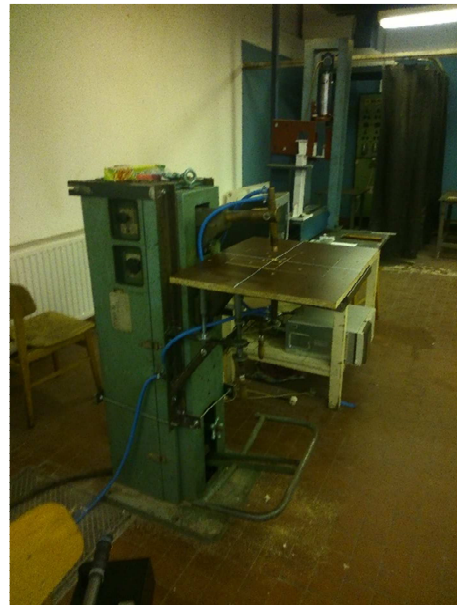
6.2 kép Állítható gépasztal egy ARO M302-A típusú hegesztő berendezéshez
