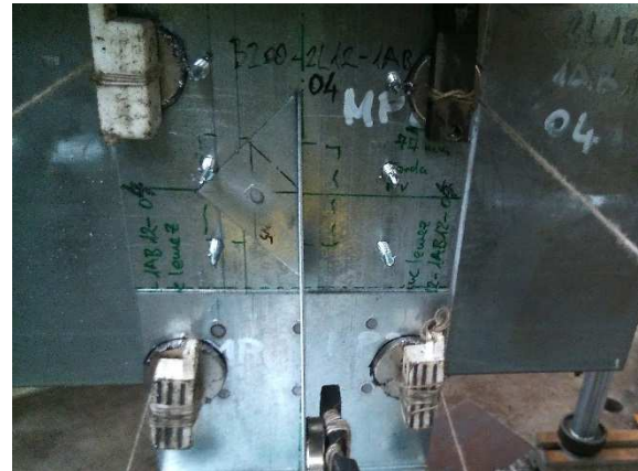
4.2 kép Mérőműszerek kialakítása: induktív adók + ajtómágnesek
