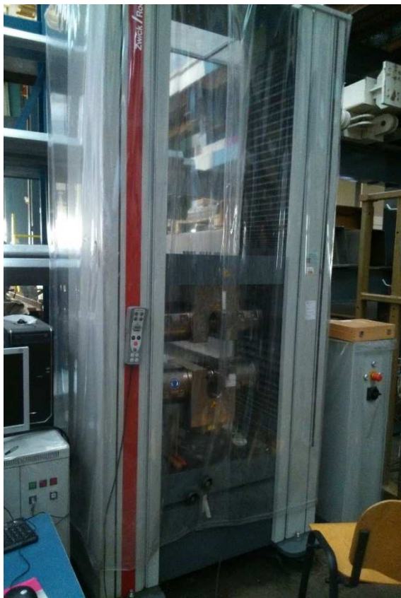
5.6 kép ZWICK Z400 szakító gép
