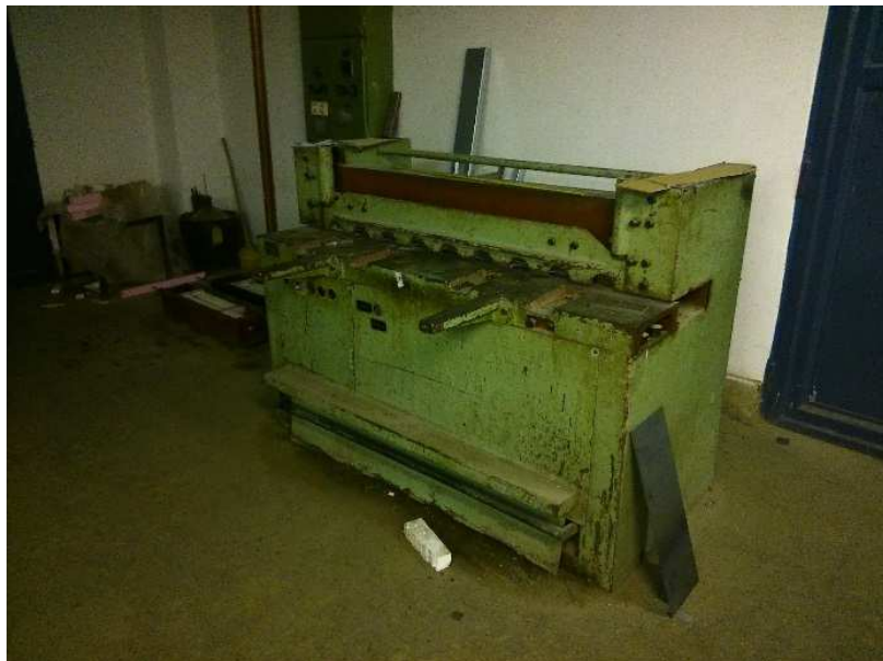
3.2 kép Próbatestek kivágása egy OL-3-1250 lemezvágó géppel
