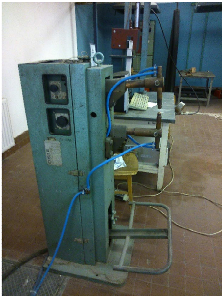
6.1 kép Az ARO M302-A típusú hegesztő berendezés
