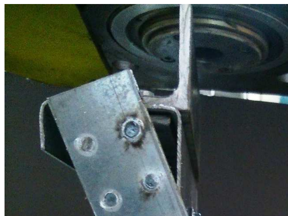
4.4 kép Terhelési viszonyok: L-acél + végbordák + övhízlalás
