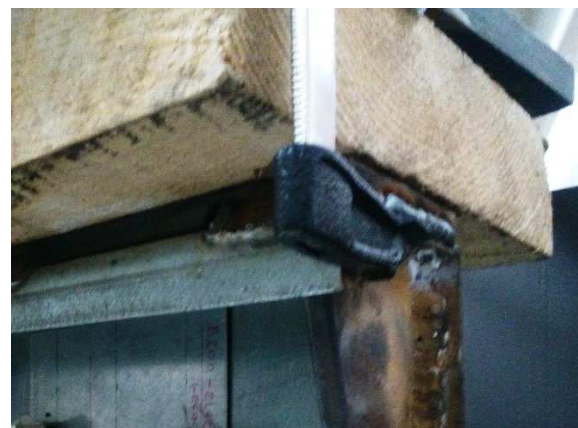
3.4 kép Terhelési viszonyok: fahasáb + pillanatszorító
