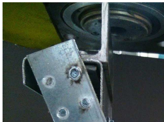
4.4 kép Terhelési viszonyok: L-acél + végbordák + övhízlalás
