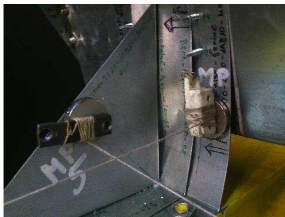
1.7 kép A deformálódott B200-...-02 tesztelem
