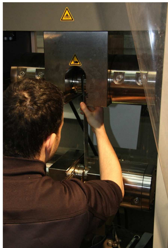
5.17 kép Próbatest befogása egy ZWICK ROLL Z400 szakítógépbe
