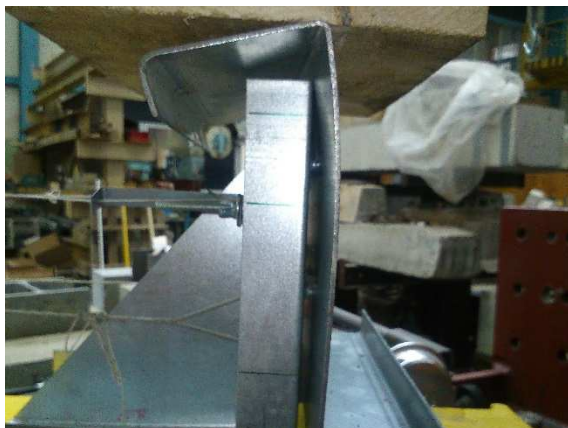
1.6 kép A deformálódott B200-...-01 tesztelem
