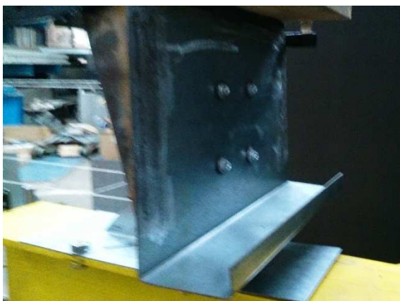
3.3 kép Z200 rögzítése a bak gerincére 4 db LD6T önfúró csavarral
