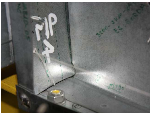
7.23 kép Gerincborda belső sarkának horpadása, a gerinc mellett
