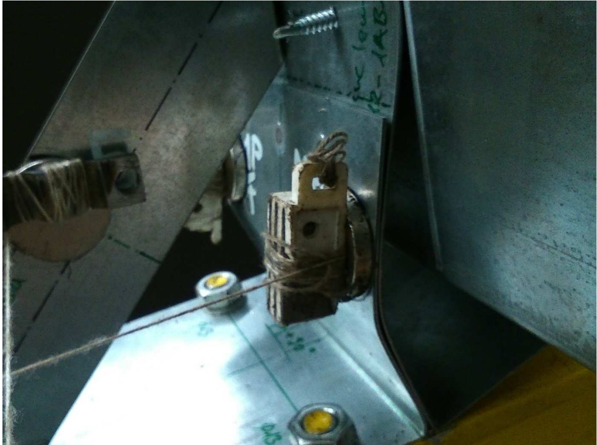
6.8 kép A gerinclemez horpadása ( F = 12,73 \text{ kN} )
