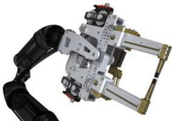
1.2 kép Gyártósorba illesztett ellenállás-ponthegesztő berendezés
