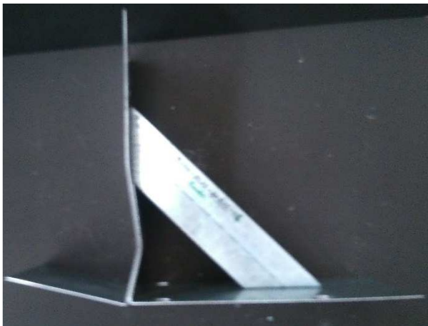
6.6 kép A bak a terhelés után
