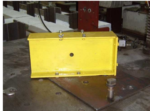
8.1 kép Gerenda felső övének kialakítása
