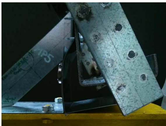
6.17 kép A bak gerinclemezének beroppánása az alaplemez gerincrészének éle felett
