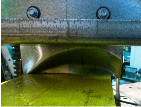
7.6 kép Gerinc lokális horpadás
