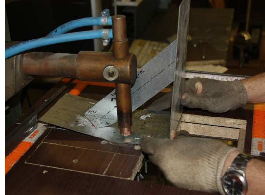
4.3 ábra Alaplemez - gerinc kapcsolat: felső elektródatartó férjen el az alaplemez mellett
