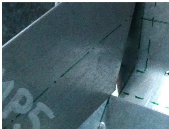
6.18 kép Borda alsó éle felül a kihorpadt gerincire
