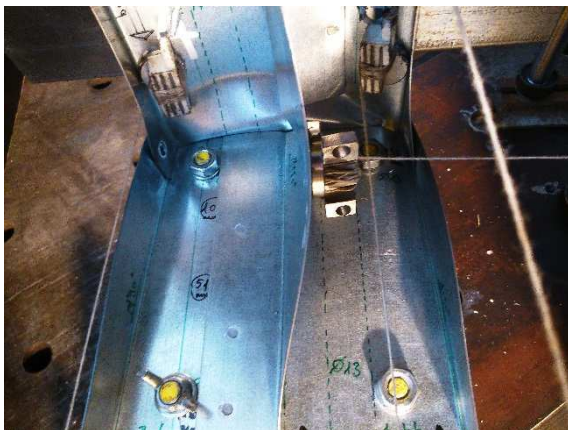
7.8 kép Bak deformálódott gerincbordája
