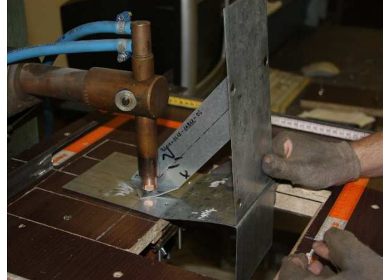
4.4 ábra Gerinclemez - borda kapcsolat: felső elektródatartó férjen el a borda mellett
