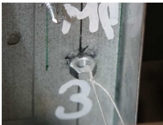
7.14 kép A mérési pontokon felragasztott anyacsavarok
