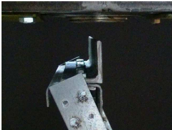
6.9 kép Terhelés bevezetése a gerincbe
