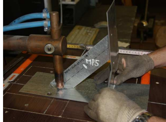
4.5 ábra Alaplemez - borda kapcsolat: felső elektródatartó férjen el a borda mellett
