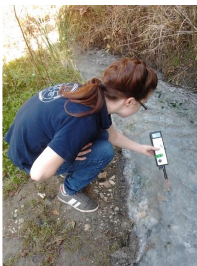
4.17. ábra Vezetőképesség mérése a Lilla-forrásnál
