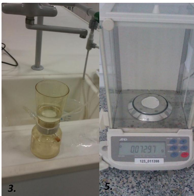
18. ábra: Lebegőanyag tartalom meghatározása (vákuumszűrés, analitikai mérleg)
