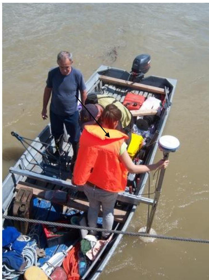
21. ábra: Csónak valamint az oldalához rögzített ADCP műszer
