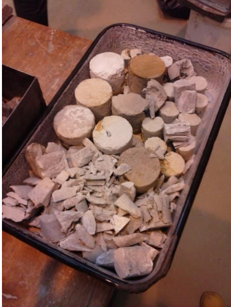
11. ábra: Próbatetek a nyomószilárdság-vizsgálat után
