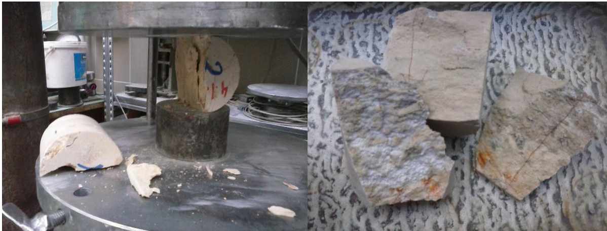
13. ábra: Próbatesszt a törés utáni pillanatban, illetve egy minta törési felülete
