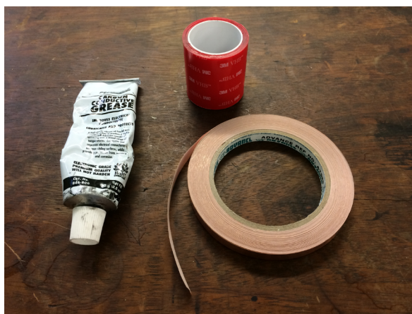
7.1. ábra. Felhasznált anyagok balról jobbra: MG Chemicals vezetőképessé kenőanyag, VHB 4905 dielektrikum, réztartalmú ragasztószalag
