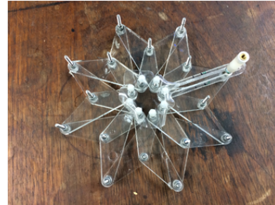
(b) A dielektrikum ráhelyezése a mechanizmusra
