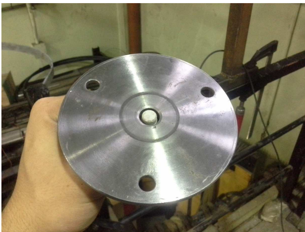
3. ábra: Az elmozdulásmérő szenzor védője, rajta az ütközések nyomával
