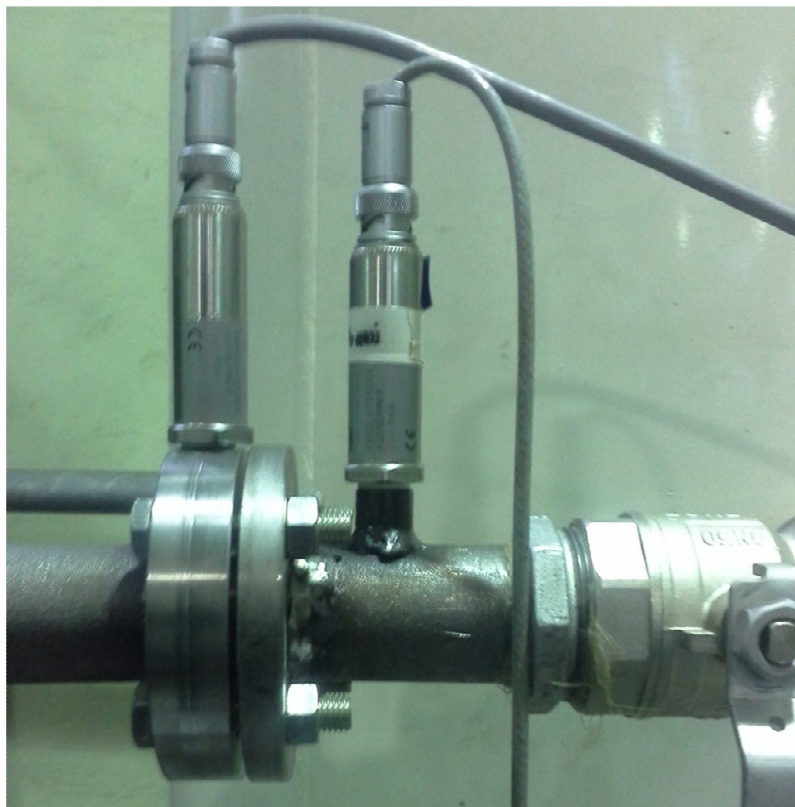
14. ábra: Nyomásmegcsapolások a szónikus fúvókán
