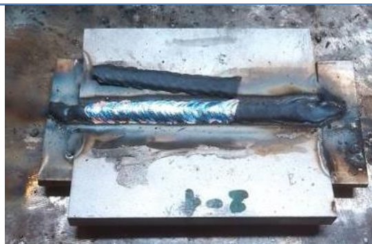
18. Ábra: Bevont elektródás töltő-takaró sor, könnyű salakleválással
