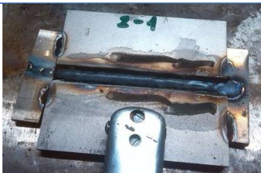
17. Ábra: Bevont elektródás töltősor, nehéz salakleválással
