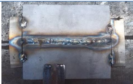
21. Ábra: Elfogadható gyökoldali átolvadás
