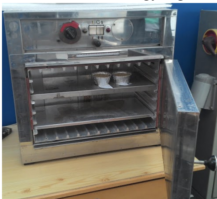
2.1. ábra Tanszéki szárítókamra a kezdeti nedvességtartalom meghatározásához
